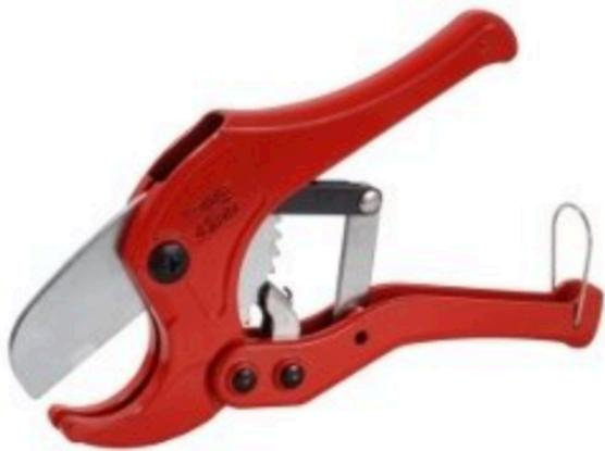
Cesoia modello **Classic 42** ha il funzionamento a leva, per ottenere una forza maggiore nel taglio. Come la classic 32 è dotata di lama intercambiabile, gancio di chiusura e apertura manuale arriva però fino ad un diametro di 42 mm.
